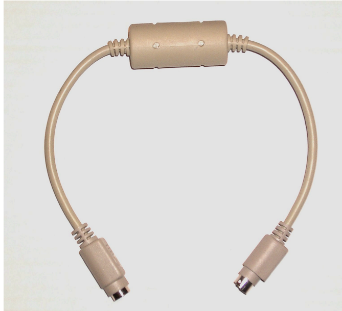
Figur 12 KeyGhost, en hårdvarubaserad tangentbordsavlyssnare
