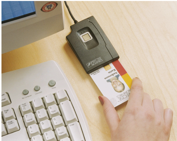
Figur 3 Autentisering i form av ett smartkort och fingeravtrycksavläsning
